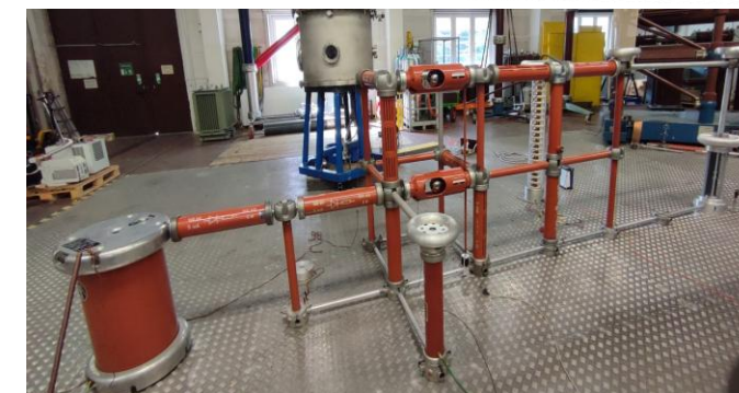
Oben: Ersatzschaltbild eines 3-stufiger Marx Unten: 2-stufiger Marx-Kreis in der Hochspannungshalle des elenia
