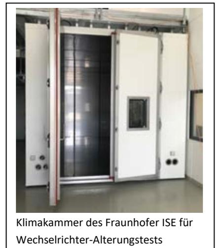
Klimakammer des Fraunhofer ISE für Wechselrichter-Alterungstests
